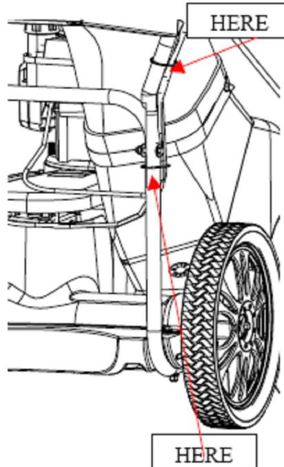
10. Подсоедините провод свечи зажигания.
