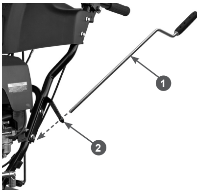
Рис. 23 Установка рычага управления поворотом жёлоба
