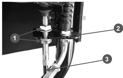
Рис. 10 Крепление оболочки троса включения хода
