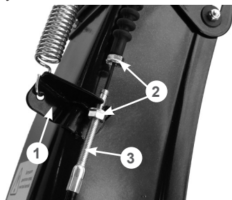
Рис. 21 Установка оболочки троса управления дефлектором жёлоба
