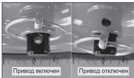
Рис.10 Перестановка шплинта на левом колесе
