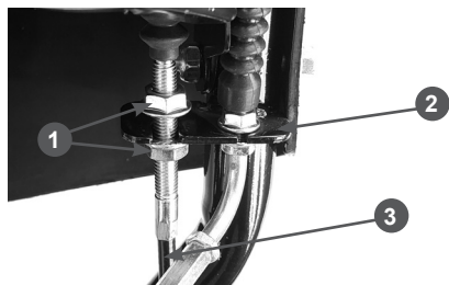
Рис. 11 Крепление оболочки троса включения хода
