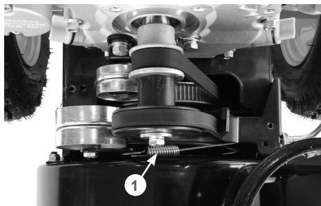
Рис. 9 Регулировка троса включения шнеков
