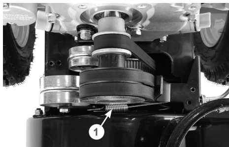
Рис. 9 Регулировка троса включения шнеков
