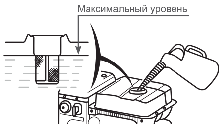
Рис. 31 Максимальный уровень топлива в топливном баке
