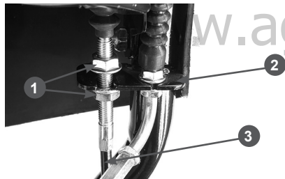
Рис. 11 Крепление оболочки троса включения хода
