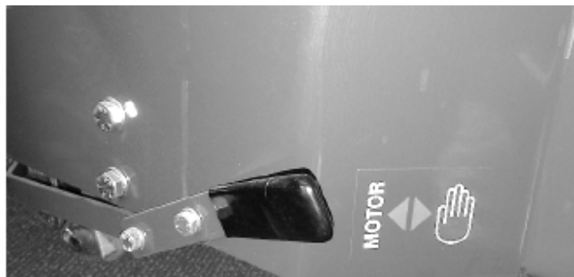
Рычаг находится за шиной левого переднего колеса
