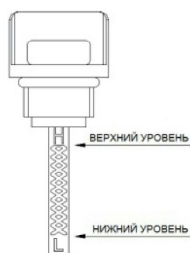
Рисунок 3. Отметки на масляном щупе.
