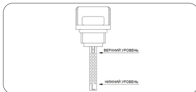
Рисунок 3. Отметки на масляном щупе.
