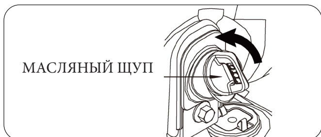
Рисунок 2. Проверка уровня моторного масла.
