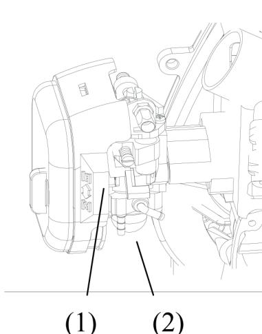
3. Установите воздушную заслонку (см. Рисунок. (2)) в закрытое положение при запуске холодного двигателя и в открытое - при запуске теплого или горячего;
