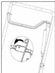
Рис. 2 Установка рычага и троса привода шнека
