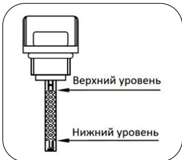
Рисунок 3. Отметки на масляном щупе.
