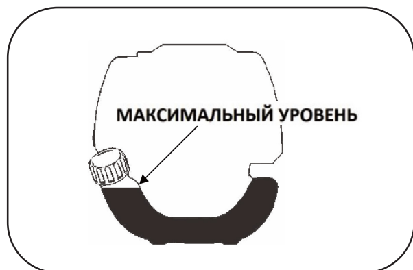
Рисунок 5. Максимальный уровень заполнения топливного бака.
