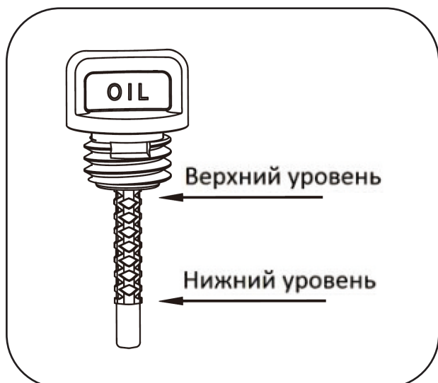
Рисунок 3. Отметки на масляном щупе.
