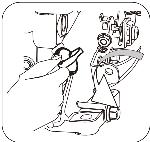
Рисунок 2. Проверка уровня моторного масла.
