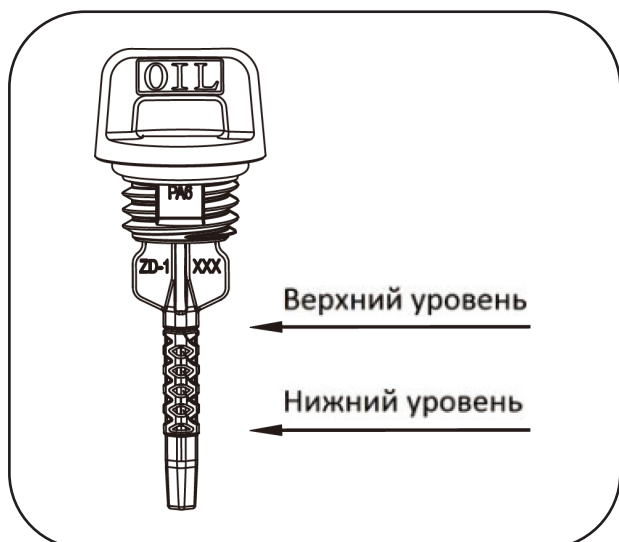
Рисунок 3. Отметки на масляном щупе.
