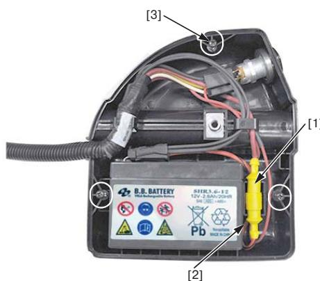
Частое перегорание предохранителя обычно вызывается коротким замыканием или перегрузкой в системе электрооборудования. Для ремонта газонокосилку следует доставить официальному дилеру Honda.
