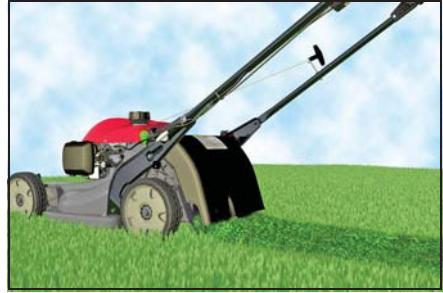
Максимальная разгрузка назад будет происходить, если рычаг направляющей скобы будет сдвинут налево до упора (положение BAG). При установке рычага направляющей скобы вправо (положение мульчирования) через задний отбойный щиток будет разгружаться меньше травы.
