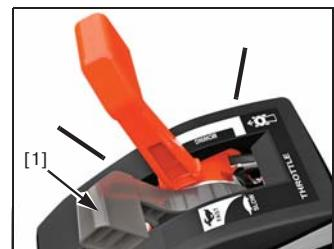
4. Переместите рычаг дроссельной заслонки [1] в положение FAST (⚡) для скашивания травы или в положение SLOW (⚡) для работы на холостом ходу.
