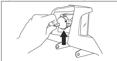
5. Вставьте лампу в фиксатор.
