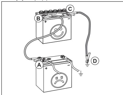
4. Подключите другой конец красного кабеля к ПОЛОЖИТЕЛЬНОЙ клемме (+) полностью заряженного аккумулятора (B).
