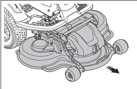
3. Поднимайте режущую деку в вертикальное положение, пока не услышите щелчок. Режущая дека автоматически фиксируется в вертикальном положении.
