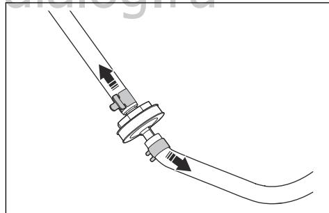
4. Стяните концы шлангов с топливного фильтра. Возможна утечка небольшого количества топлива.
