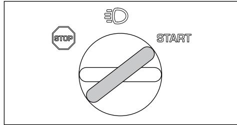
**Примечание:** Не включайте стартер более чем на 5 секунд за раз. Если двигатель не запускается, подождите 15 секунд перед повторной попыткой.
