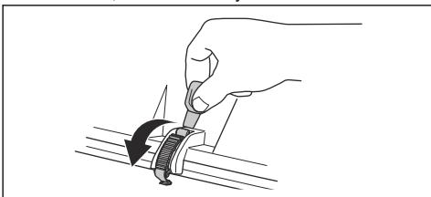
5. Поднимите опору регулировки высоты стрижки и установите ее в держатель.
