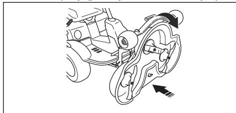
4. Извлеките опору регулировки высоты стрижки (A) из держателя и поместите ее в отверстие.
