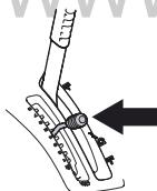
6. Нажмите кнопку блокировки на рычаге подъема режущей деки и опустите ее в рабочее положение.
