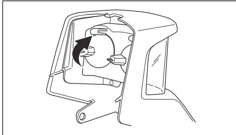
6. Вставьте нижний конец крышки лампы в отверстия на рулевой колонке.
