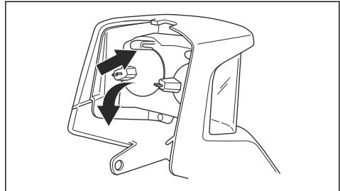
4. Вставьте новую лампу в нижний паз на корпусе лампы. Используйте тип лампы, указанный в разделе *Технические данные на стр. 34*.
