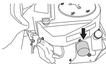
Нанесите на резиновую прокладку нового фильтра небольшое количество нового масла. Смонтируйте масляный фильтр, повернув его по часовой стрелке. Поворачивайте усилием руки, пока резиновая прокладка не будет прилегать. Затяните потом еще на пол оборота.
