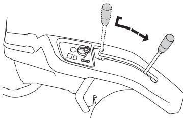
При перемещении рычага вперед режущая дека опускается, и ножи автоматически начинают вращаться (положение сктрижки).
