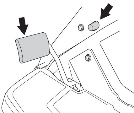
Блокировочная кнопка стояночного тормоза автоматически выключается при нажатии педали тормоза.
