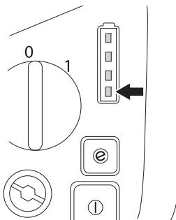
Если машина остановилась и ее необходимо переместить к зарядной станции, следует извлечь предохранитель свободного хода в задней части каретки. Не забудьте установить предохранитель обратно перед зарядкой аккумулятора.
