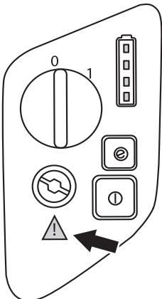
В случае возникновения неисправности оборудования лампа загорается красным цветом.
