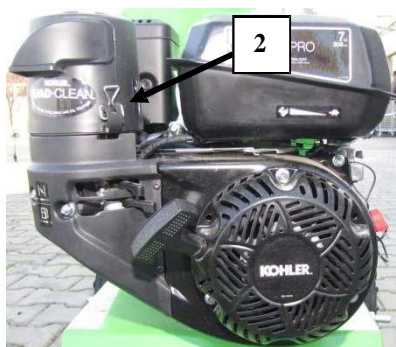
Воздушный фильтр с центробежной функцией для разделения грязи и сухого элемента (2) под корпусом.
