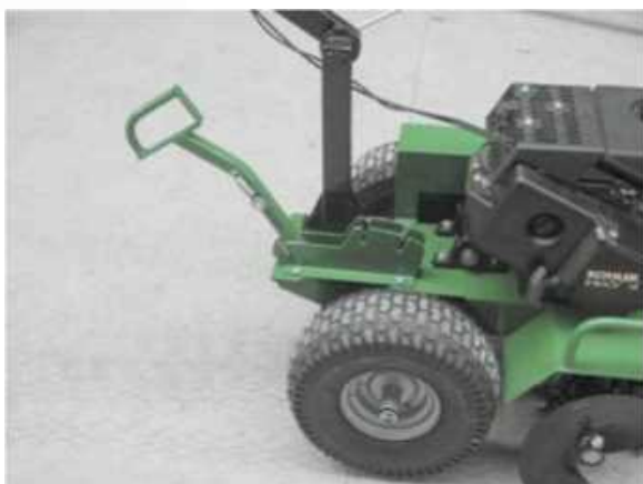
Установка рычага заглабления в положении DOWN
