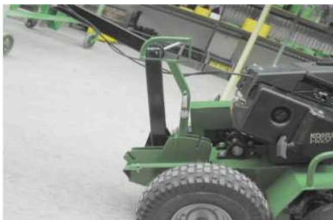
Установка рычага заглабления в положении UP
