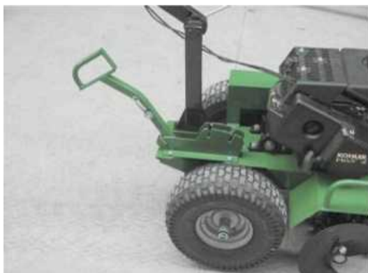
Установка рычага в положении UP
