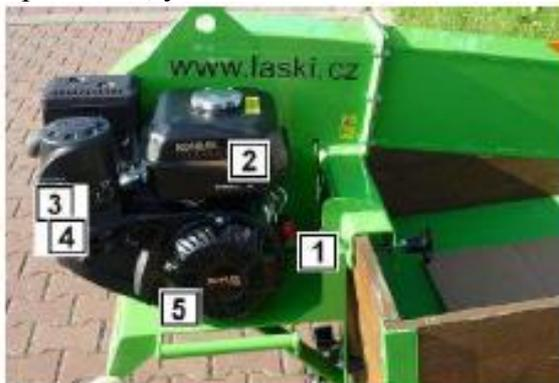
1 – Коробка зажигания, 2 – Регулятор числа оборотов, 3 – Дроссель, 4 – Топливный кран, 5 - Вербка
