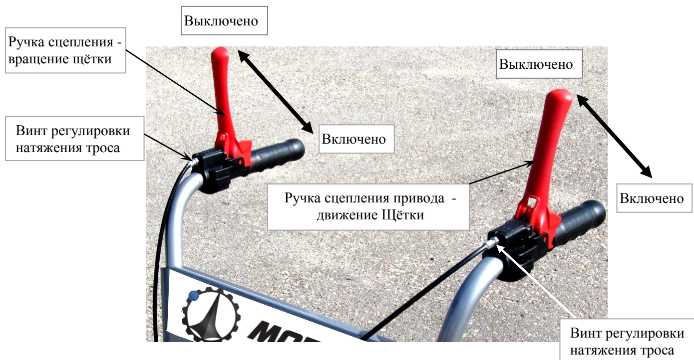
РИС. 4 СХЕМА ВКЛЮЧЕНИЯ РУЧЕК СЦЕПЛЕНИЯ СНЕГОУБОРЩИКА С65 – ВРАЩЕНИЕ И ДВИЖЕНИЕ ЩЁТКИ.
