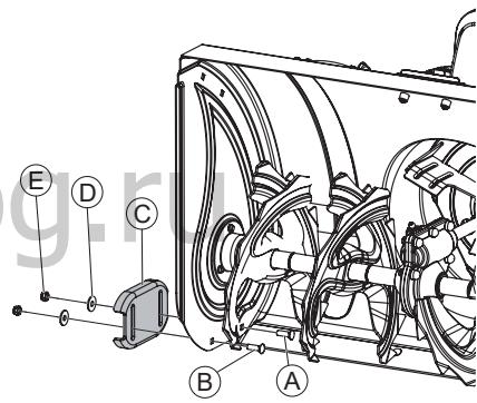
Для предохранения от повреждений частей ковша снегоуборочной машины установите башмаки по его обеим сторонам. Используйте детали крепежа: (A) болт M8×25 – 2 шт.; (B) болт M8×20 – 2 шт.; (D) гроверная шайба D8 – 4 шт.; (E) Гайка M8 – 4 шт.
