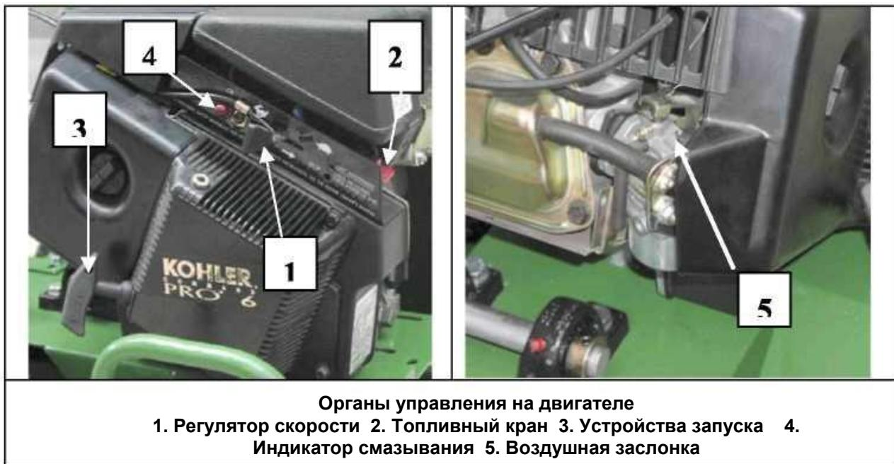
Если воздушная заслонка открыта в течение длительного промежутка времени после запуска, это может привести к "затоплению" карбюратора и остановке двигателя. Избыток топлива в камере сгорания увеличивает износ двигателя. Оставляйте заслонку открытой на время прогревания двигателя до его работы на холостом ходу. Не используйте воздушную заслонку в то время, когда работаете.
