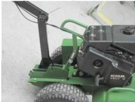
Установка рычага в положении DOWN II
