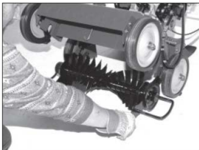
1) Задвинуть узел скарификатора в корпус
