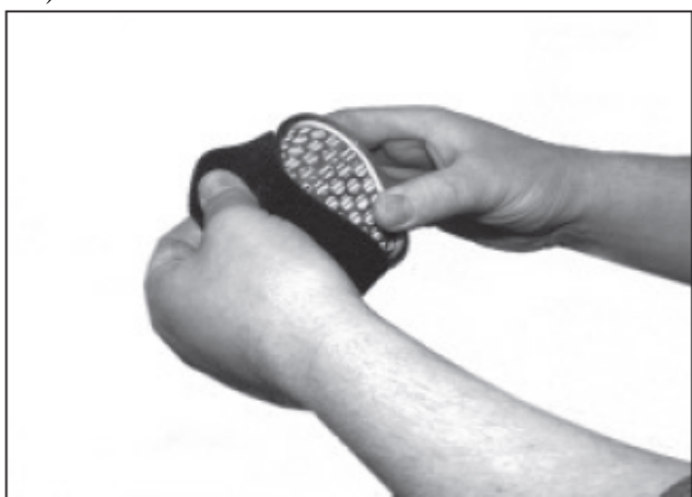
5) Осторожно снять фильтр губой очистки и очистить пластины.
