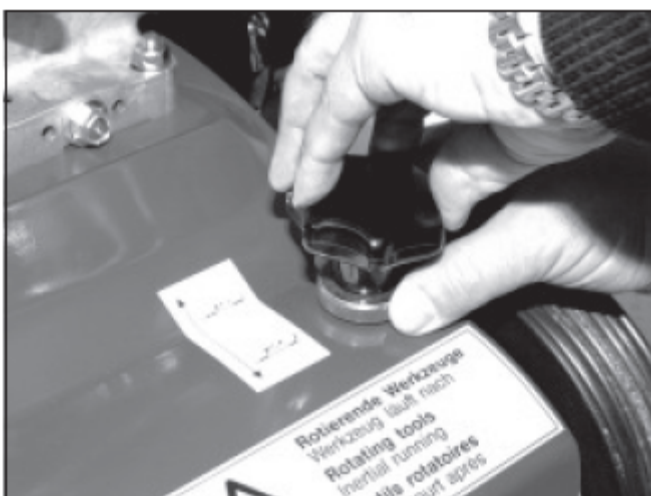
5) Снова затянуть контргайку, зафиксировав тем самым регулировочный винт.
