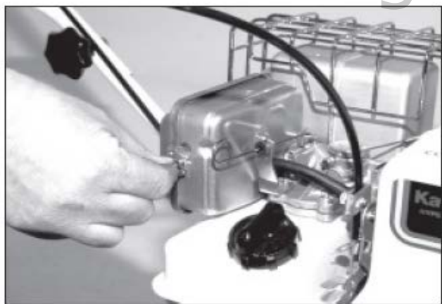
1) Ослабить болт крышки воздушного фильтра.
