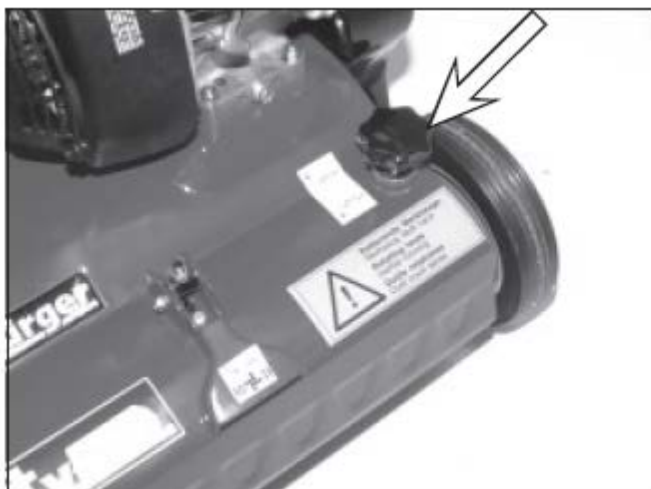
1) Регулировочный винт скарификатора
