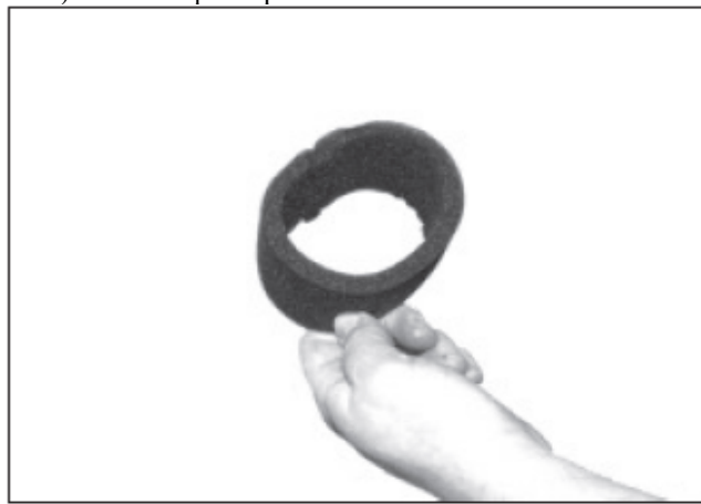
6) Осторожно выбить фильтр грубой очистки или очистить сжатым воздухом.
