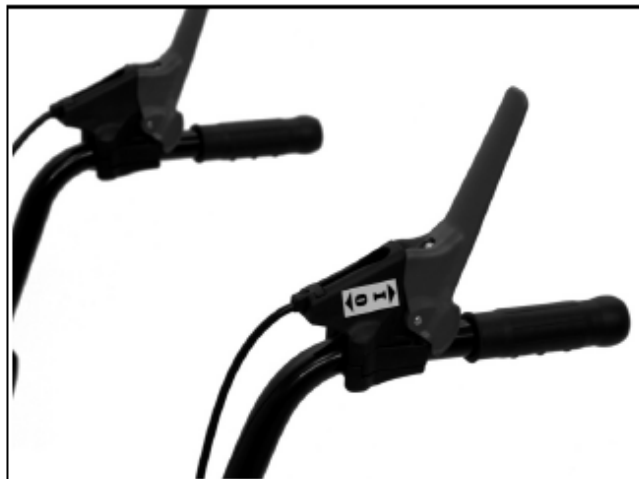
2) Переключающий рычаг находится в исходном положении
