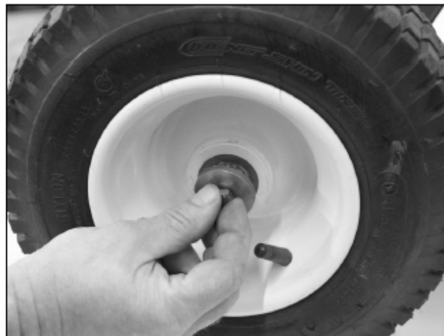
8) Установить болт с гайкой
