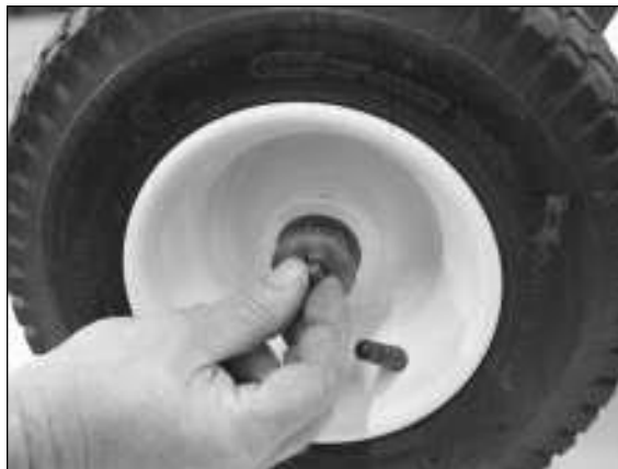
Закрепите винтом с шайбой.
