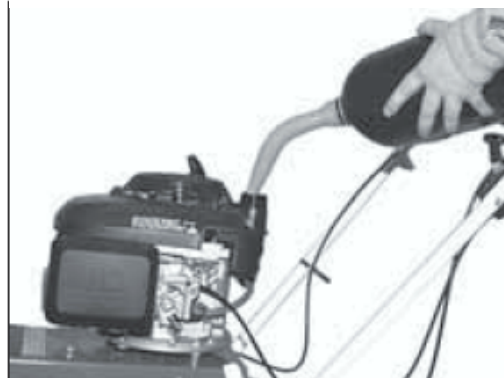
2. Держите канистру как изображено выше. Только когда заполняете маленькими количествами, и проверяйте уровень топлива каждый раз до и после заправки.
