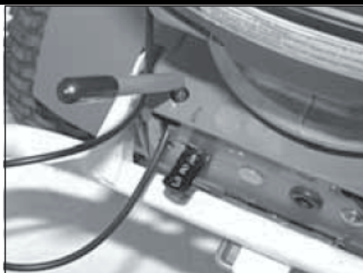
1. Рычаг переключения передач вверх : 1я передача – медленно
