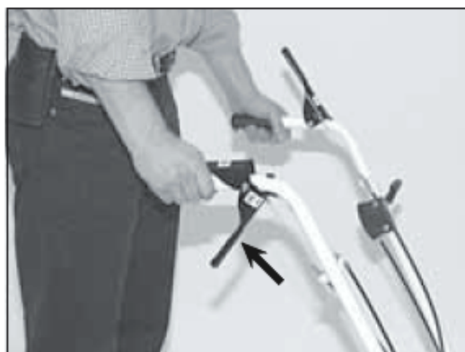
1) Данный рычаг задействует заднюю передачу.
