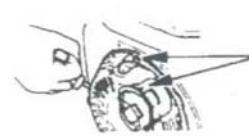
Совместите отметку на шкиве стартера с отверстием на корпусе механического стартера
