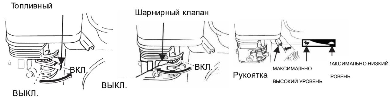
4. Поверните переключатель двигателя в положение включения.
